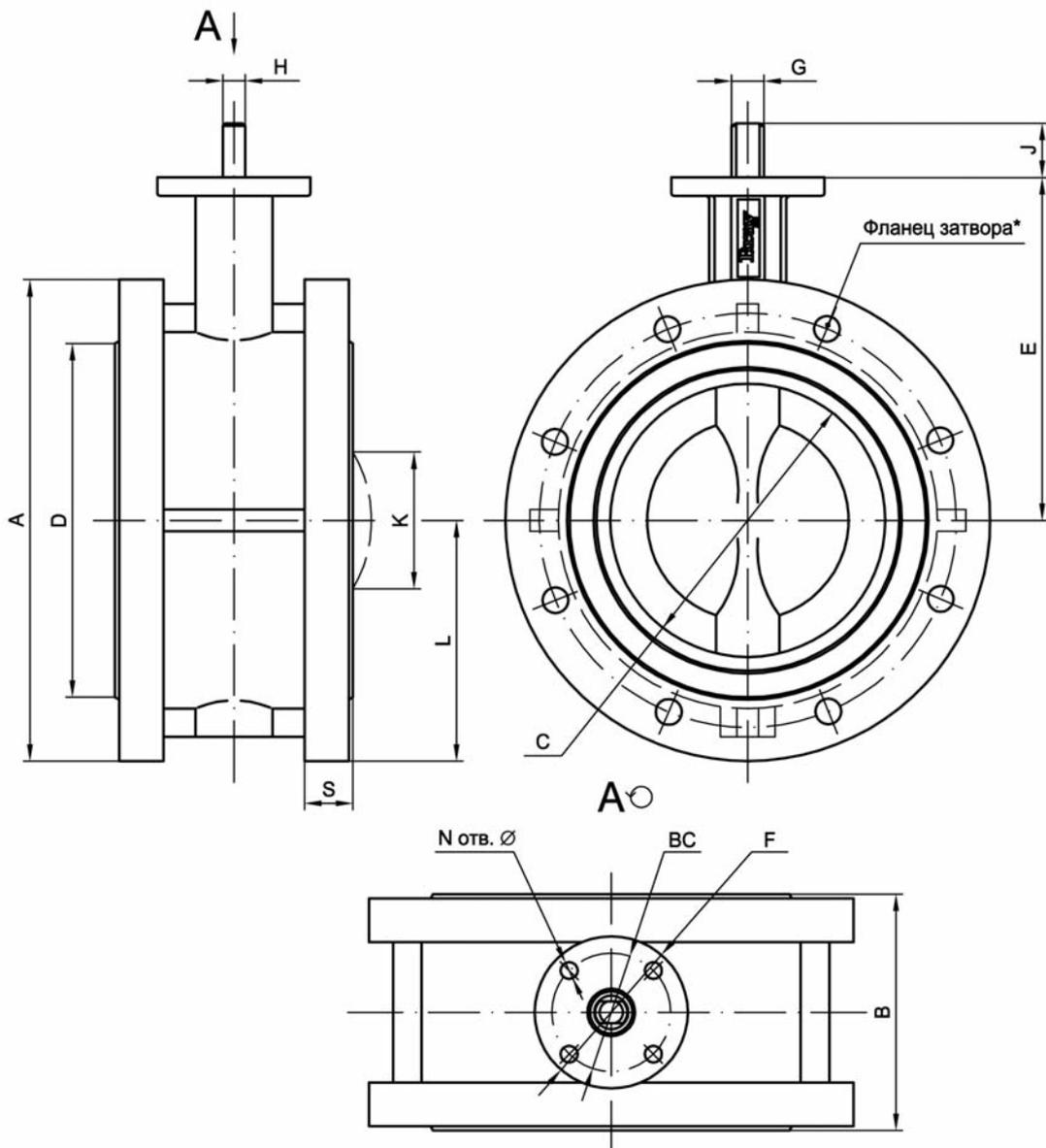
**Габаритные размеры затворов дисковых поворотных серии 3А(Н) DN 350...500**
